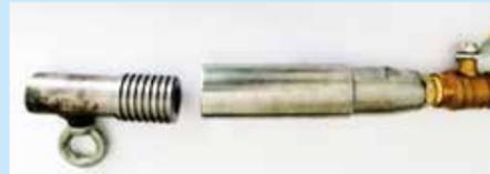
**IIIa.** COLOCAR LA LANZA AL HOLDER HASTA QUE TOQUE EL FONDO DEL ANTIRRETORNO (verificar imagen).
