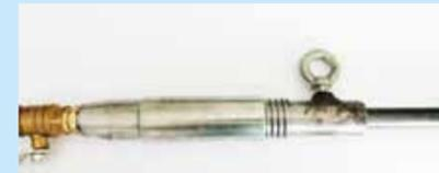
**V.** CUANDO LA LANZA ESTE CONSUMIDA EN UN 80%, APAGAR EL OXIGENO Y COLOCAR LA NUEVA LANZA PARA CONTINUAR CON EL CORTE (Utilizar el acofle si se desea unir la siguiente lanza térmica).
