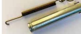
Facilitador para ignición o encendido inmediato de la lanza.
