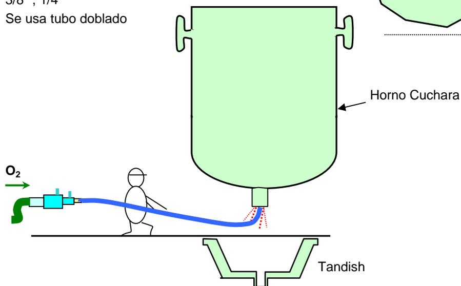
4) Limpieza de boquillas de Tandish o apertura de boquillas obstruidas
